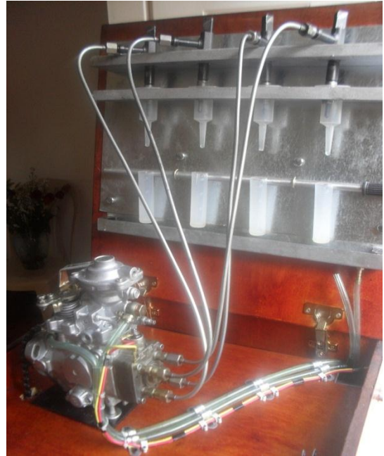
SISTEMA DE BOMBA E INYECTORES
