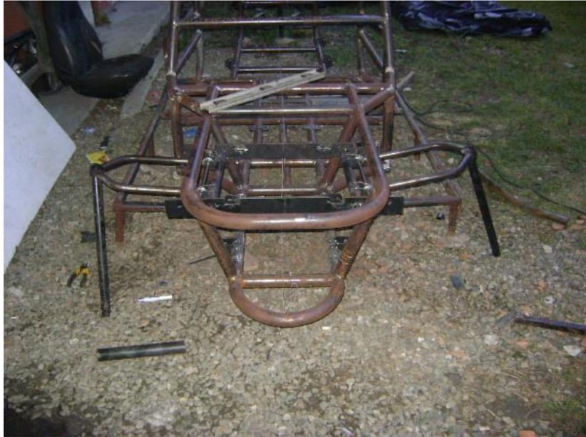
*Figura 78. Pruebas de ensamble de trapecios delanteros.*
