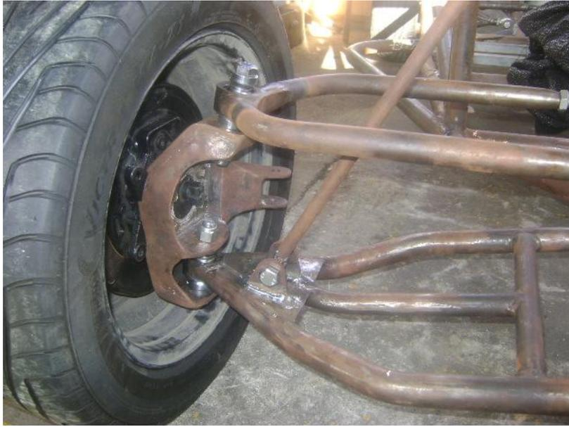
*Figura 80. Ensamble de suspensión delantera.*
