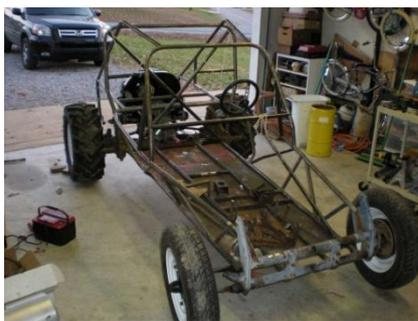
*Figura 2. Buggy con suspensión de Volkswagen Beetle. [4]*
