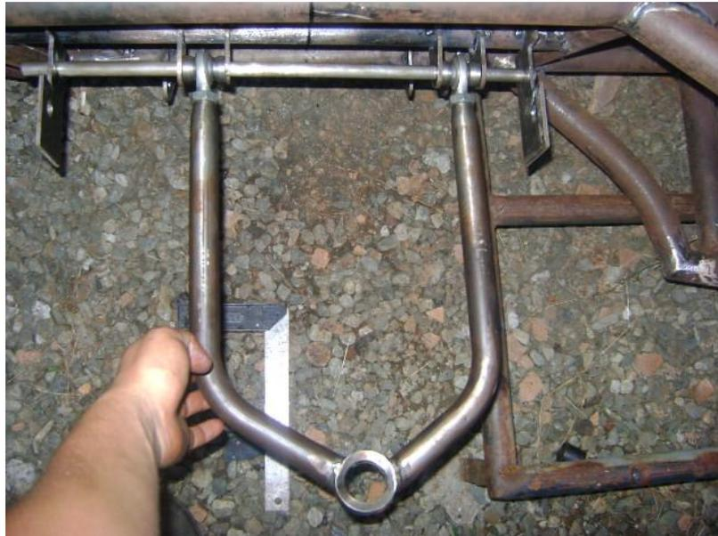
*Figura 75. Ensamble de las soportes de trapecios superiores al chasis.*
