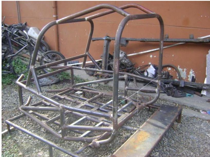
*Figura 67. Chasis cortado, listo para empezar a modificarse.*
