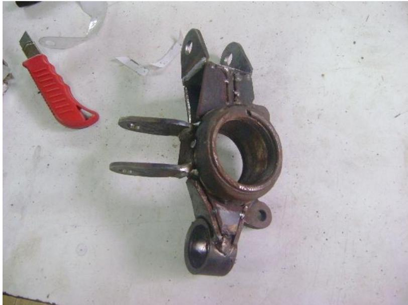
*Figura 60. Porta mangueta trasero en proceso.*
