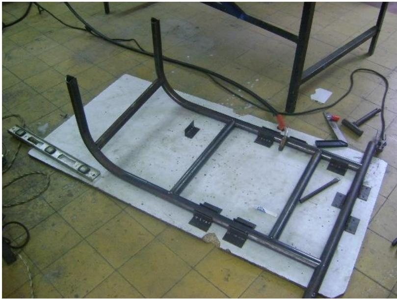
*Figura 68. Matriz par ensamble de la parte trasera del chasis.*
