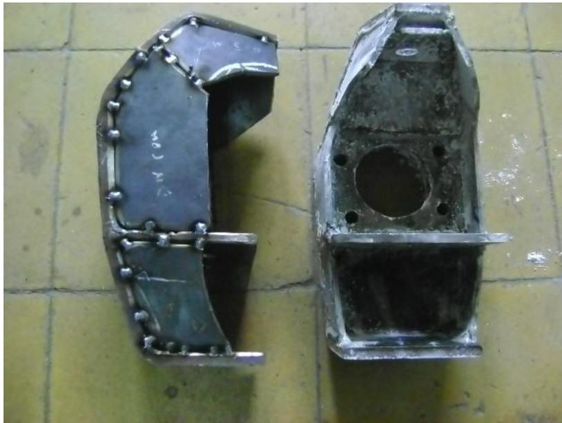
*Figura 64. Porta manguetas delanteros antes de soldarse y pulirse.*
