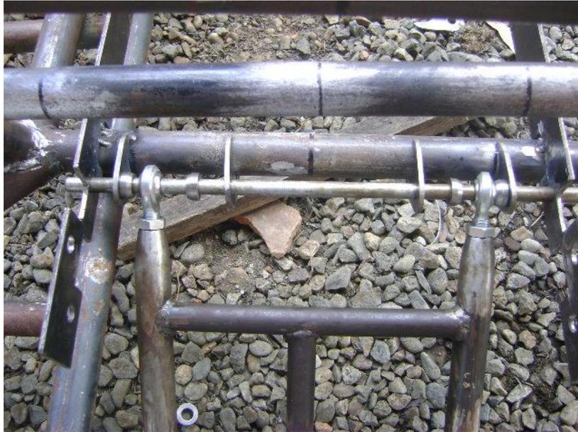
*Figura 74. Ensamble de los soportes de trapecios inferiores.*
