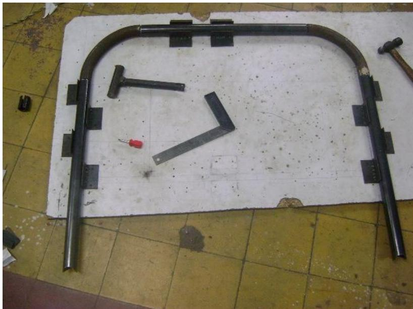
*Figura 69. Matriz de ensamble para la jaula trasera del chasis.*
