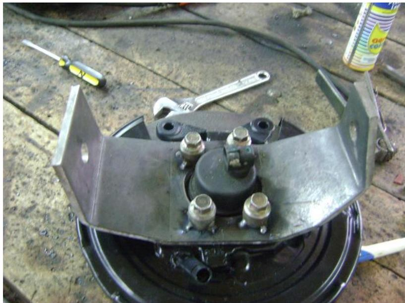
*Figura 63. Ensayo de la platina de porta mangueta en el disco de freno.*
