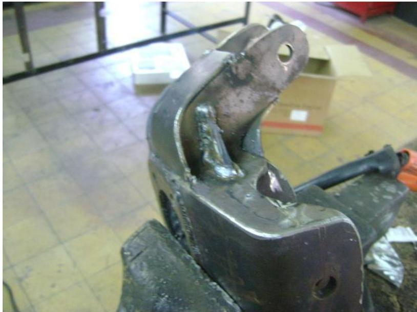
*Figura 65. Adaptación del brazo pivote de dirección al porta mangueta.*
