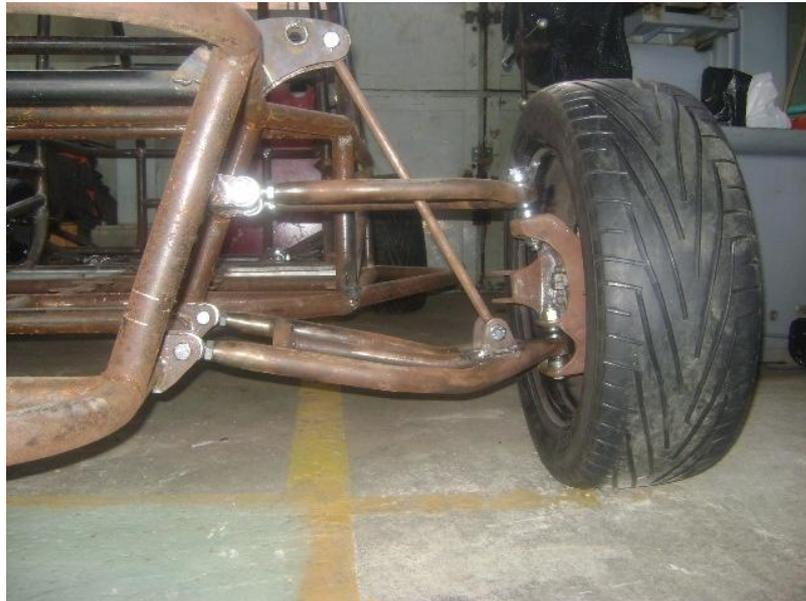
*Figura 79. Ensamble de suspensión delantera.*
