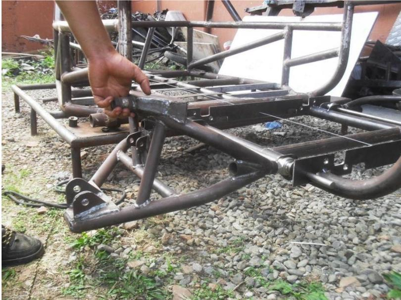
*Figura 76. Ensamble de los soportes de trapecios traseros al chasis.*
