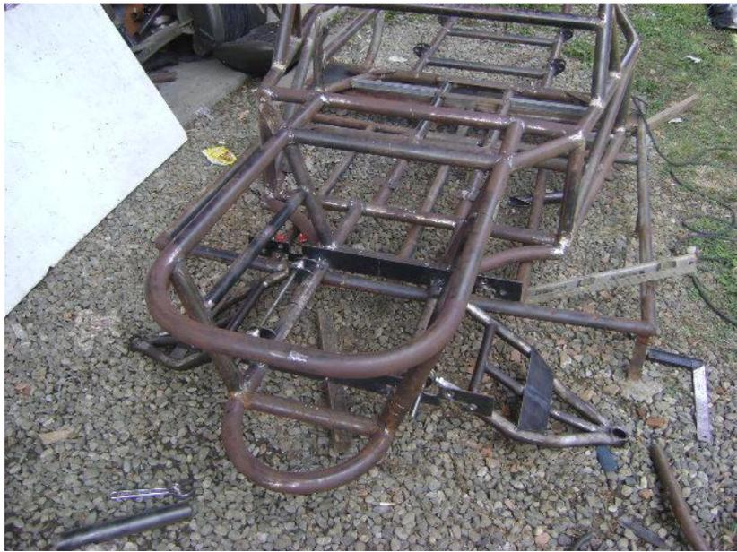
Figura 72. Ensamble de los soportes de trapecios inferiores al chasis.
