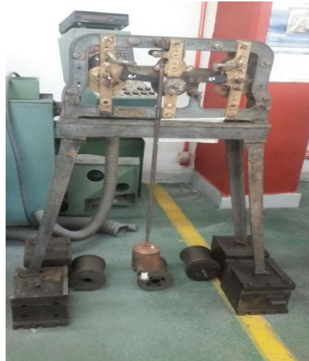
Figura 21. Maquinaria completa del reloj en reparación
