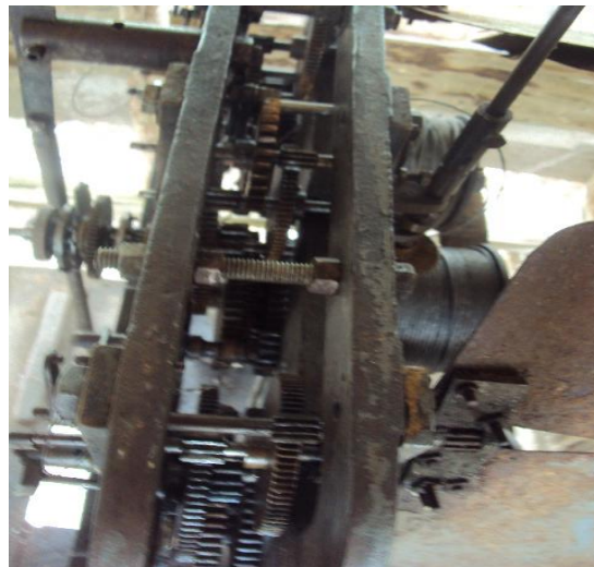
Figura 7. Desmote del reloj para evaluar las piezas dañadas
