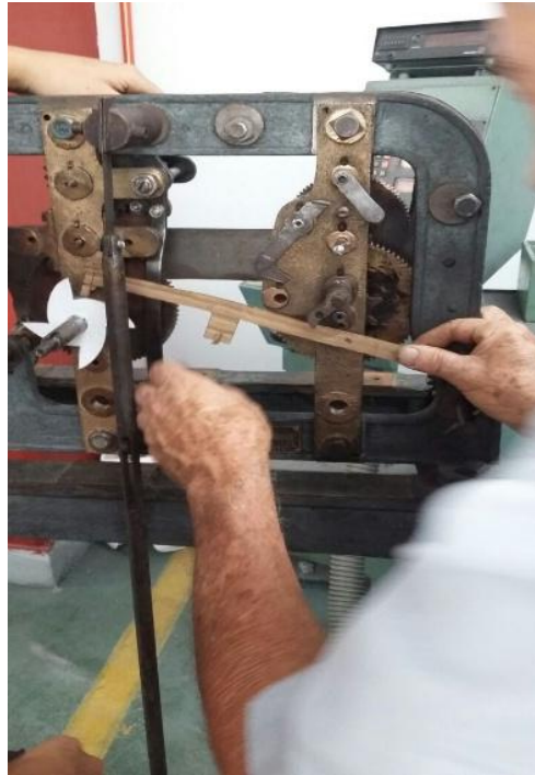
Figura 20. Diagnóstico de las piezas faltantes del reloj
