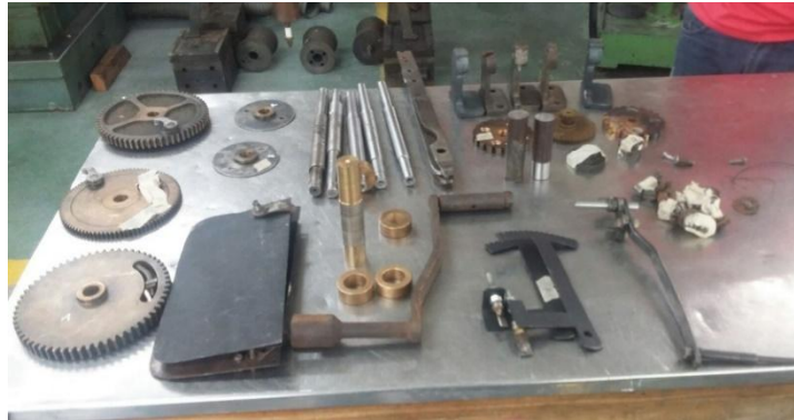
Figura 22. Desmote de las piezas del reloj
