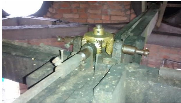
Figura 12. Transmisión de engranaje para las cuatro caras del reloj
