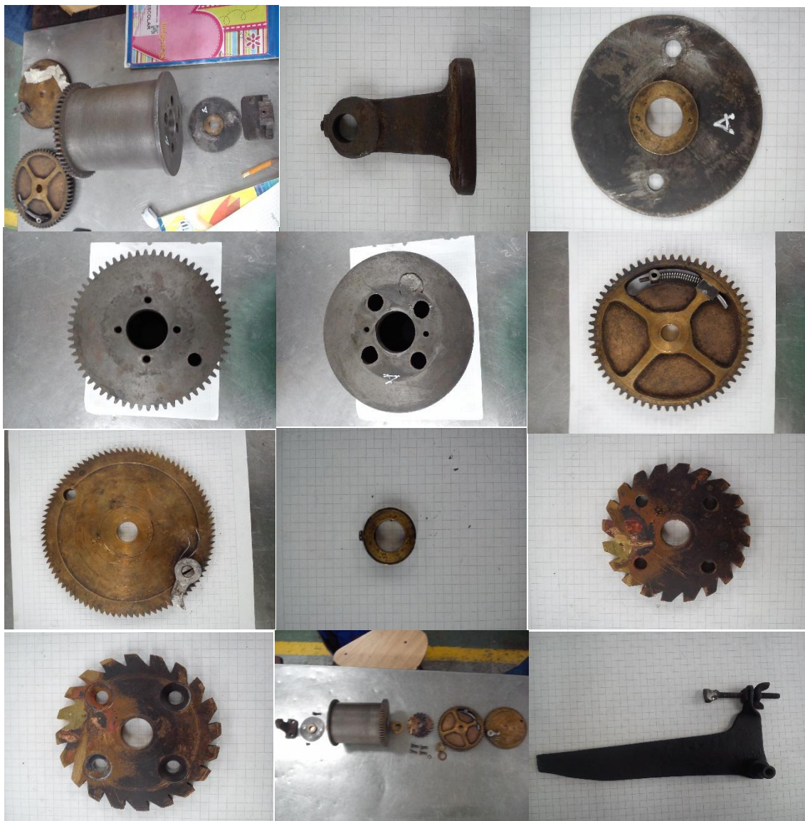
Figura 14. Detalle de las diferentes piezas del reloj para su limpieza y/o reparación
