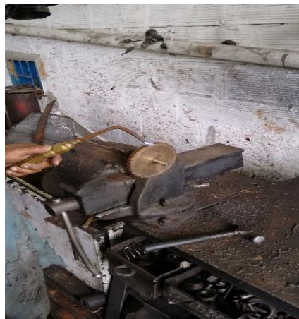
Figura 19. Reparación de engranajes
