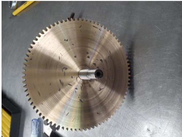
Figura 16. Recuperación de engranaje
