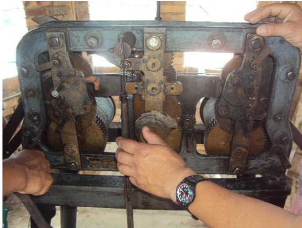
Figura 11. Desmoste de las piezas del reloj
