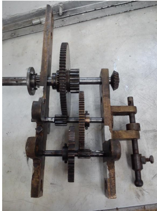
Figura 18. Desmonte de la maquinaria central del reloj
