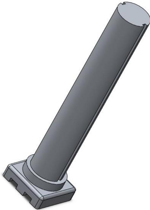
Brazo extensible en aluminio, donde va ubicado el cilindro N°2 que se encarga de abrir y cerrar la pinza que sujeta los conos, este brazo extensible va acoplado a la base cilíndrica y a su vez se mueve de arriba abajo gracias al cilindro N°1
