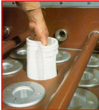
Figura 15. Fijación de mangas con fleje metálico. [12].
