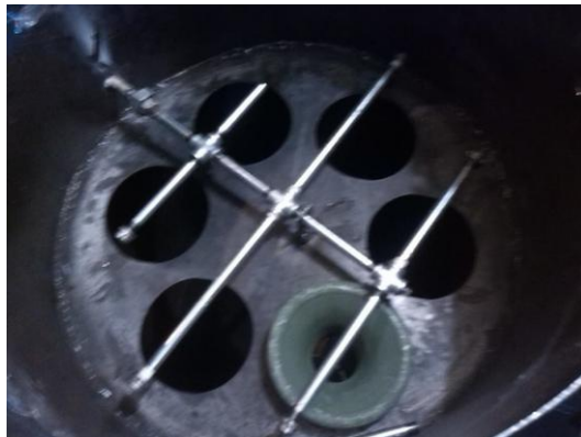
Figura 35. Montaje de succión, pulmón y acople del ventilador
