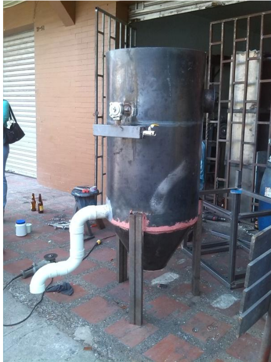
Figura 35. Montaje de succión, pulmón y acople del ventilador
