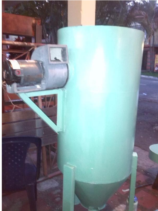
Figura 39. Instalación de motor ventilador
