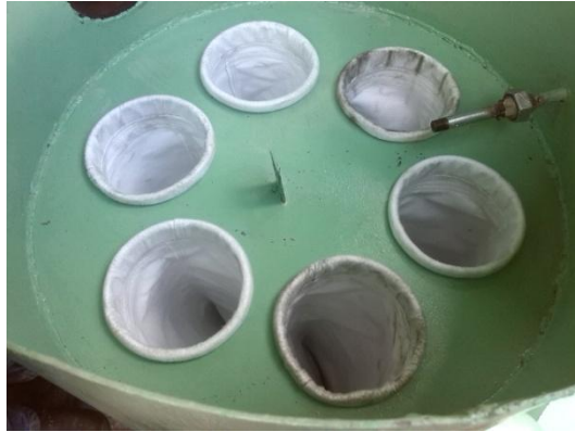
Figura 37. Fijación de espejo y ubicación de mangas
