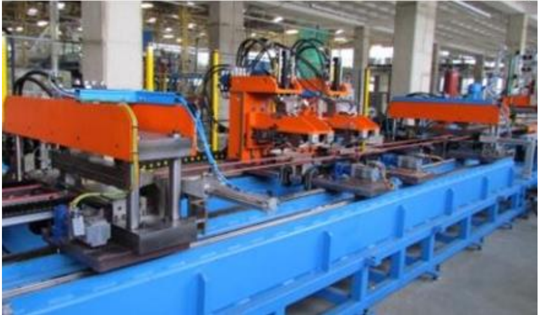
Imagen 6. Conformado de gabinete
