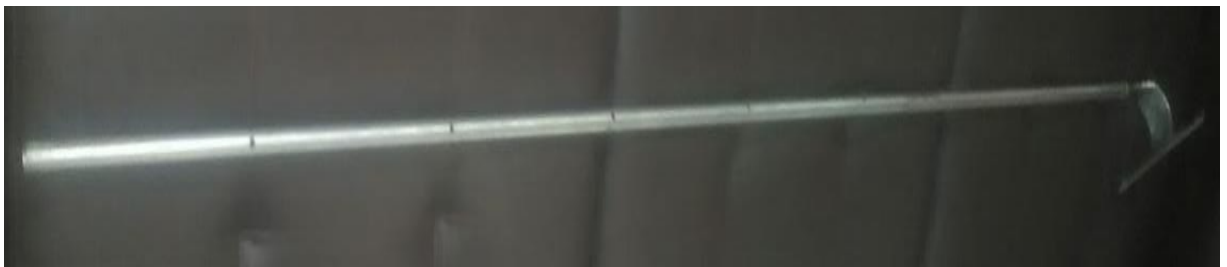
Figura 9: tubo de \frac{3}{4} y \frac{5}{8} de acero inoxidable norma 304 de 1500 mm de ensamble
