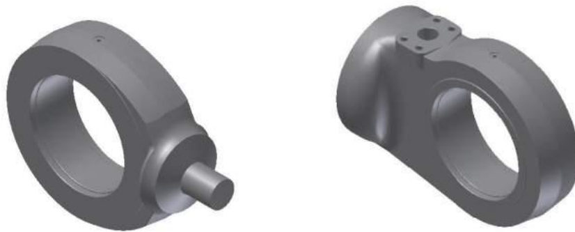
Figura 18. Pivotes delantero y trasero de un cilindro.
