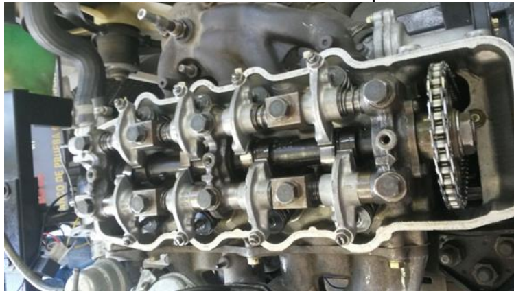
Ilustración 17 árbol de leva reparado
