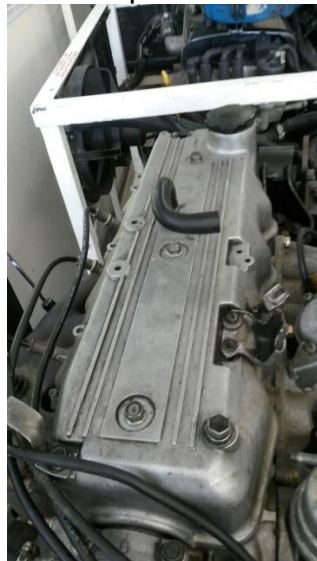
Ilustración 14 tapa válvulas reparada
