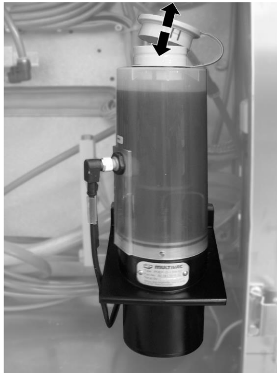
Figura 6. Depósito de aceite
