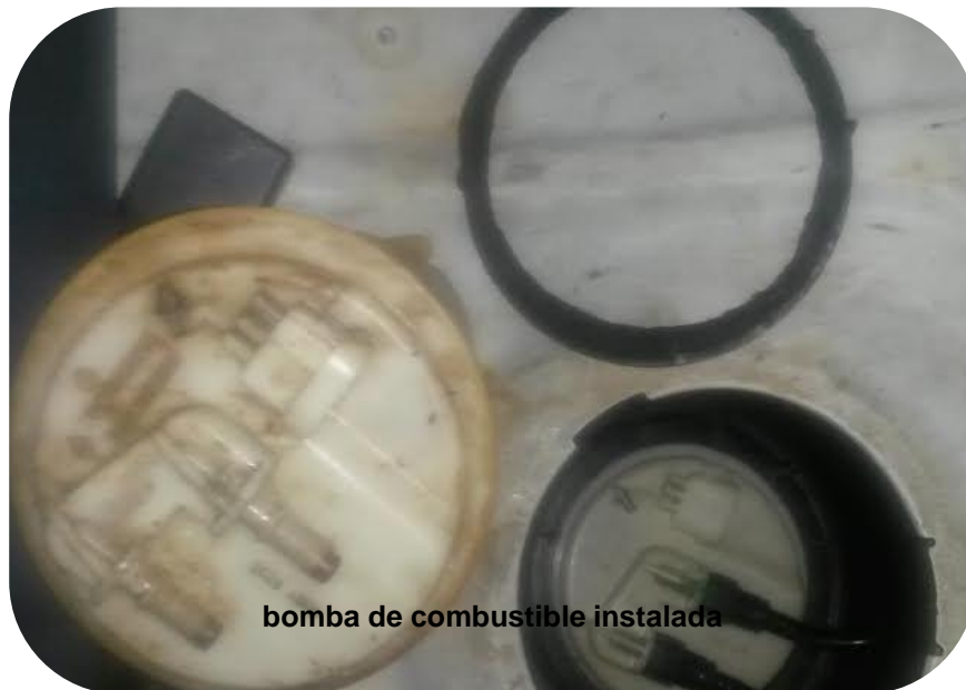
Ilustración 7. Cambio de bomba de combustible y tapa rosca
