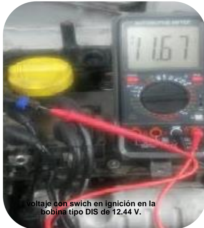
Ilustración 13. Voltaje en el conector de la bobina DIS
