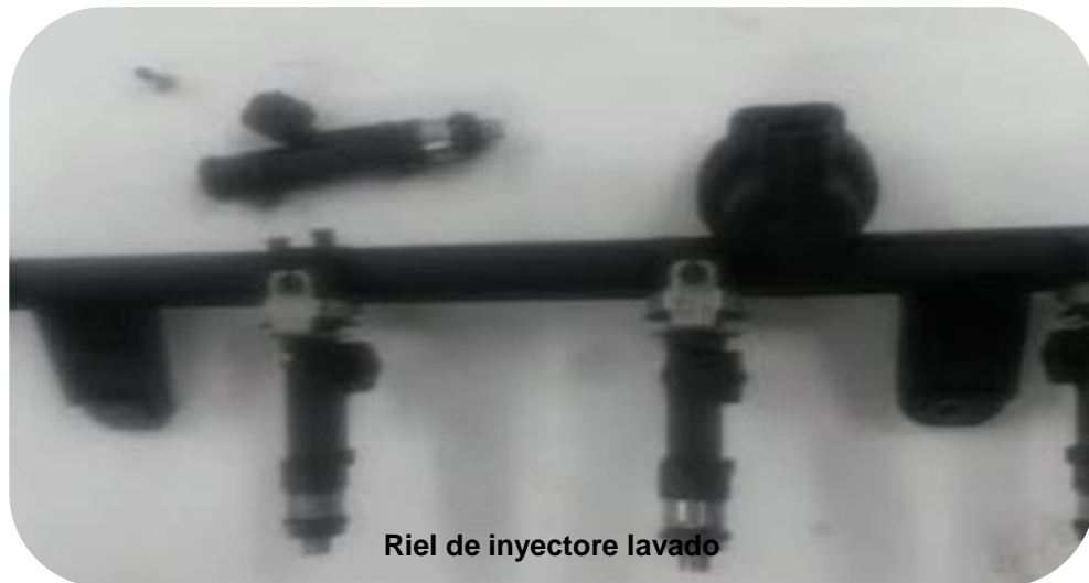
Ilustración 9. Riel y juego de inyectores lavados.
