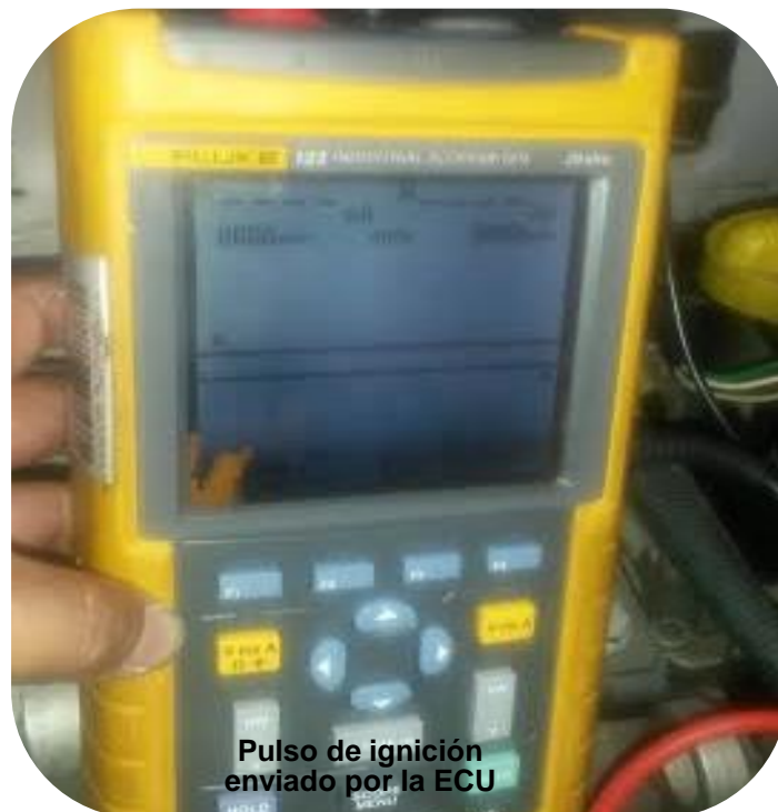
Ilustración 15. Pulso enviado por la ECU a la bobina DIS
