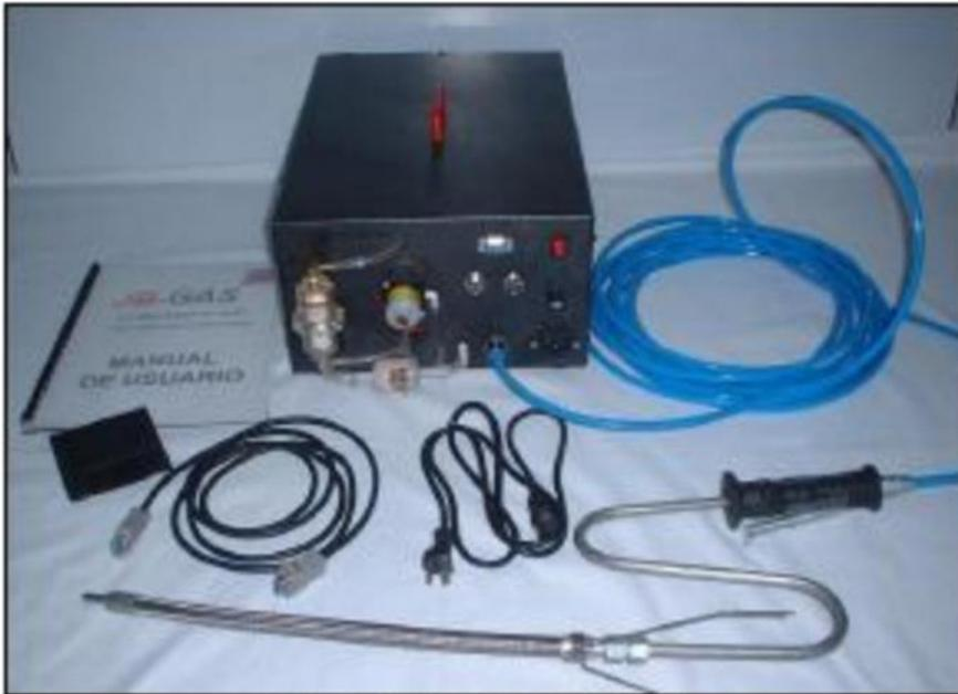
Equipo diseñado para medir la concentración de gases en una muestra de humos de combustión bajo el método de infrarrojo no dispersivo (NDIR) y celda electroquímica para medición de O<sub>2</sub>
