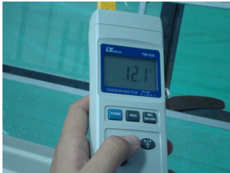
Ilustración 21 Mediciones de temperatura de aire a la salida del evaporador
