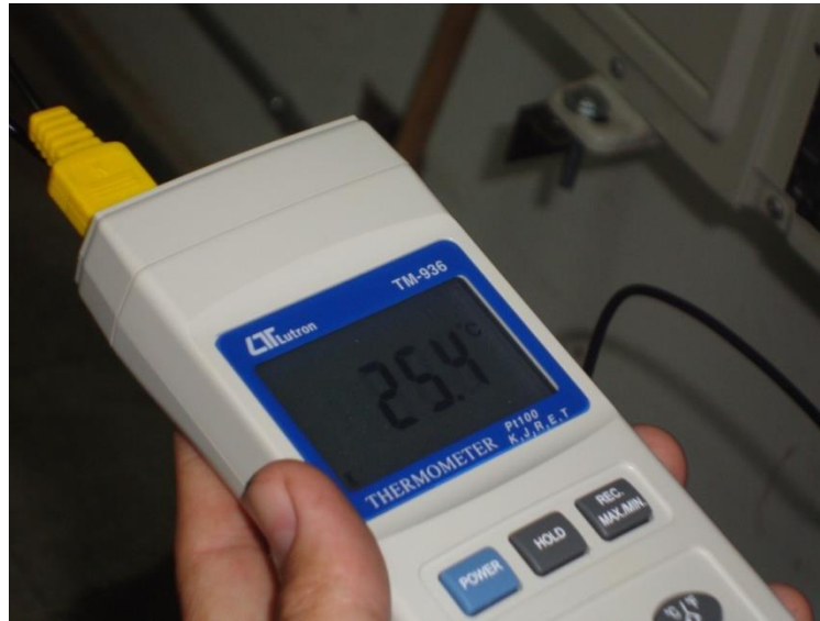
Ilustración 22 Medición de temperatura a la entrada del evaporador
