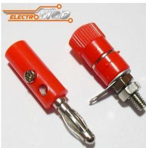
Figura 16. Conectores tipo banana hembra y macho
