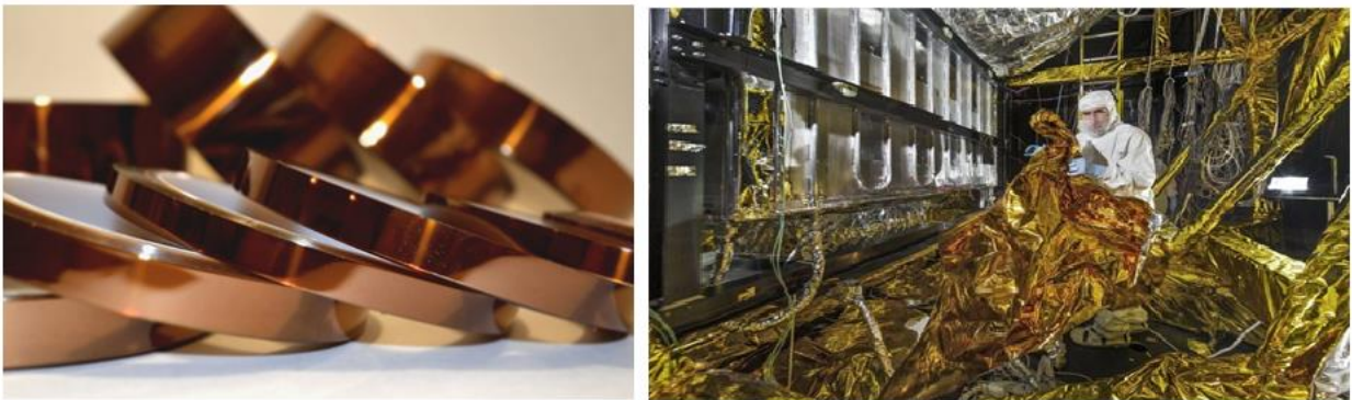
Figura 5. Material Kapton utilizado en la electrónica
