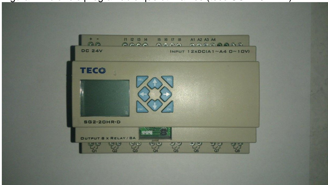
Figura 1. Plc o relé programable que utilizamos (teco SG2-20HR-D)
