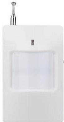
Figura 3. Sensor de movimiento PIR
