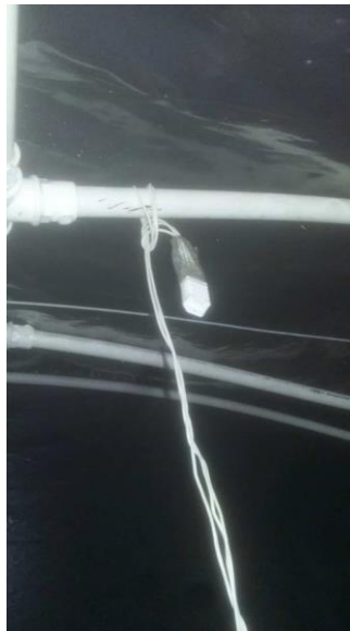
Figura 11. Sensor AM2302 en la parte superior de la marquesina Fuente: propia
