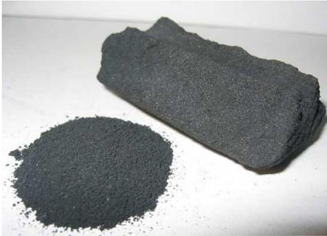
Se diseña normalmente para remover cloro, sabores y olores y demás químicos orgánicos. También es uno de los procesos finales del sistema de tratamiento de agua, su función es pulir la descarga final. Son fabricados en acero al carbón de alta resistencia y recubrimiento interno de polietileno para evitar la corrosión. Retrolavado 100% automático, con temporizador o volumen tratado.
