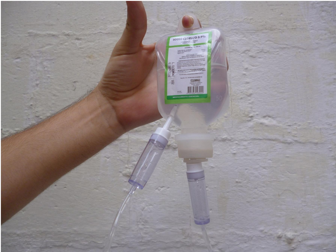
Foto 44: Parte seis experimento Ensamble de las mangueras reguladoras de caída
