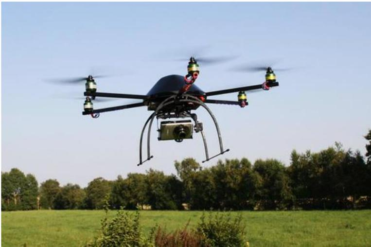
Este hexacóptero es propiedad de la Policía Británica y pesa 1,2 kg, posee seis dispositivos de rotor y tiene una duración de vuelo de hasta 36 minutos, además puede llevar alrededor de 1 kg de peso, este curioso aeromodelo de un cóptero con 6 hélices, está equipado con un localizador GPS y lleva integrada una cámara de alta definición que ofrece unas imágenes increíbles de sus vuelos.
