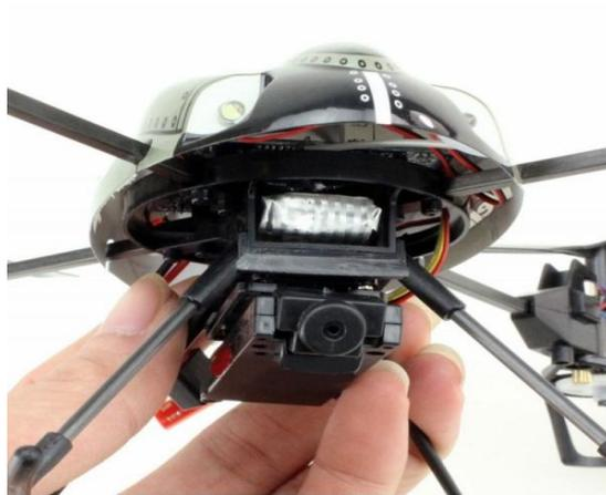
Entre los dispositivos y sensores electrónicos que sirven para controlar la aeronave están: Motores para las 4 hélices, giroscopio electrónico, acelerómetro, micro controlador, módulos de comunicación inalámbrica, baterías.
