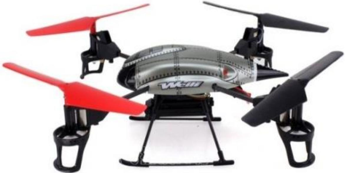
Cada parte en el diseño de un cuadricóptero trabaja en conjunto. El bastidor es la unión de todas estas partes, se puede diseñar de muchas maneras y con muchos tipos diferentes de materiales, un diseño más eficiente conlleva un bastidor más rígido, ligero y que permita reducir al mínimo las vibraciones introducidas por los motores, la parte central donde se encuentran montados los sensores del sistema y la placa electrónica de control, cuatro brazos montados en la parte central.
