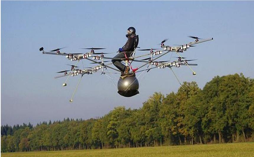
La compañía reconoce que la duración de las baterías da como para comprar el pan, pero no el pan y el periódico, así que trabaja en una versión dotada de un motor híbrido de gasolina que sirve para recargar las baterías que alimentan los motores.
