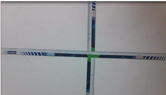
Las mediciones se obtuvieron utilizando un patrón métrico dispuesto de forma paralela a la parte delantera del cuadricóptero para apreciar la extensión de la componente en el eje “x” del cuadro de visión; para el eje “y” se presentó un patrón métrico de forma perpendicular al patrón anterior para poder medir la magnitud de la ventana de visión con respecto a este eje, para todos los planos de visión se siguió el mismo procedimiento.
