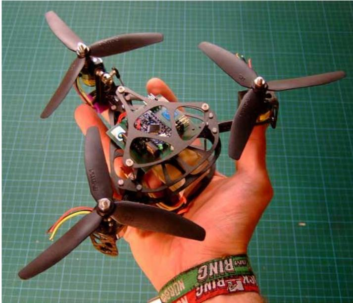
Este es un tricóptero casero de tan sólo 300 gramos que se basa en un pequeño Arduino Pro Mini con un conjunto de giroscopios para su estabilización mediante AHRS. El chasis fue diseñado con Sketchup de Google y las piezas fueron cortadas con una cortadora láser.
