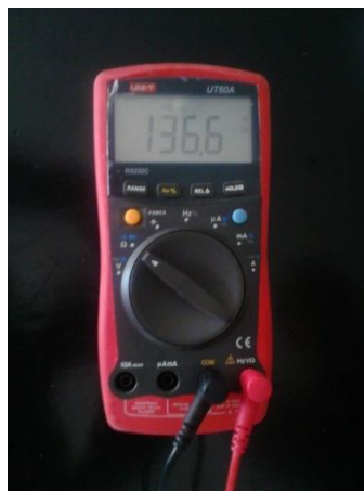
Figura 44. Valor de resistencia bobina contactor Fuente: propia
