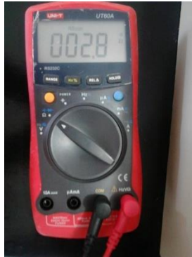
Figura 42. Multímetro en escala de continuidad Fuente: propia
