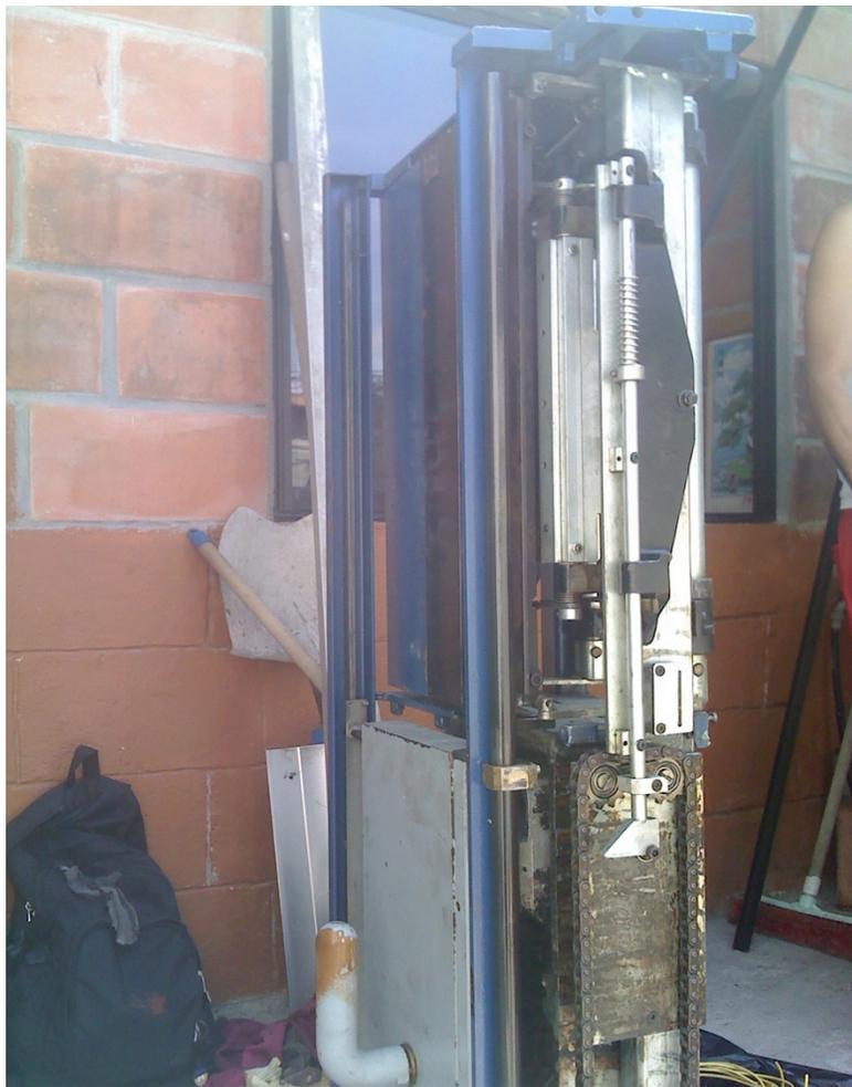
**Fotos 7 Desmontaje de soporte de cadena y motor**
