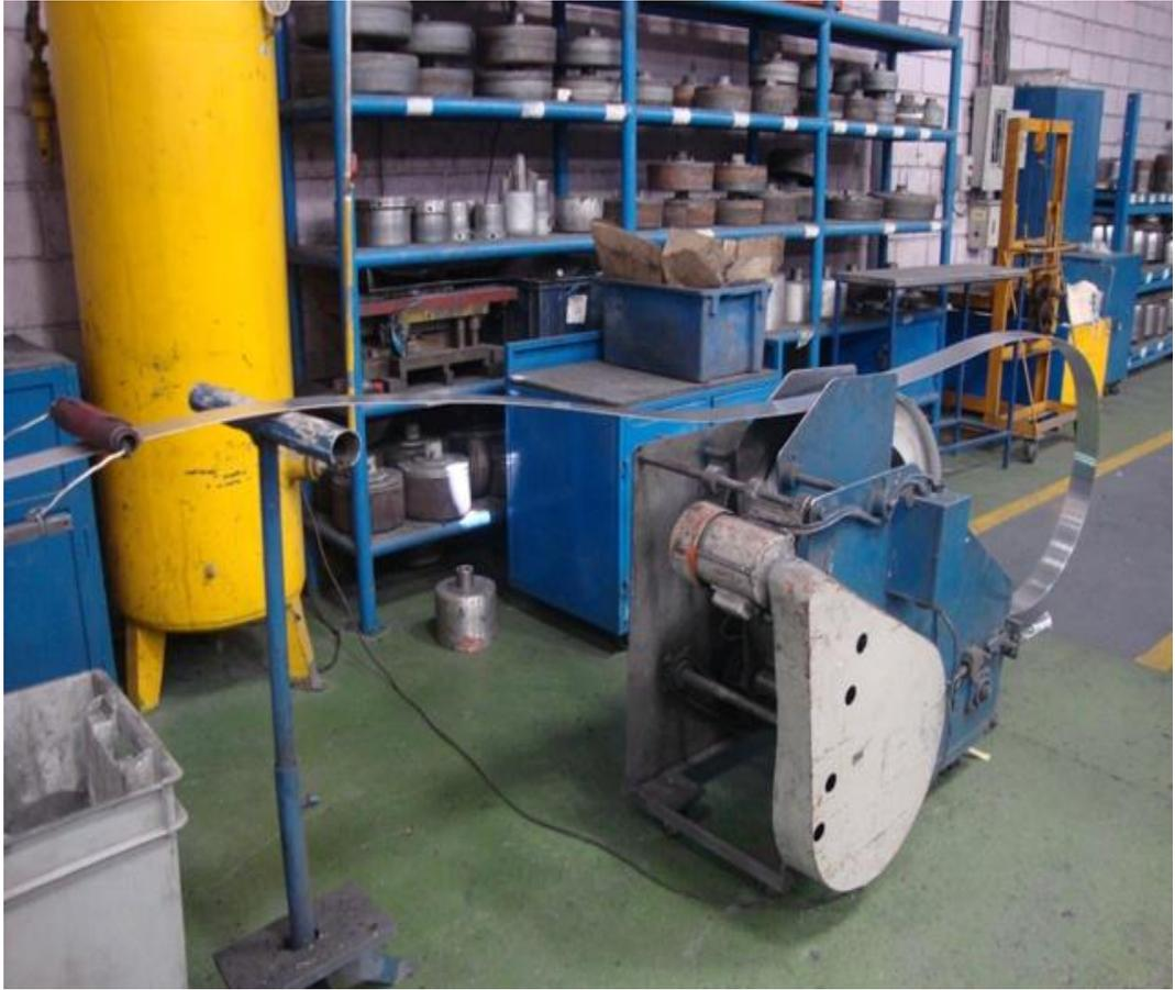
Dispensador del rollo del fleje de aluminio automático sincronizado con la prensa.
