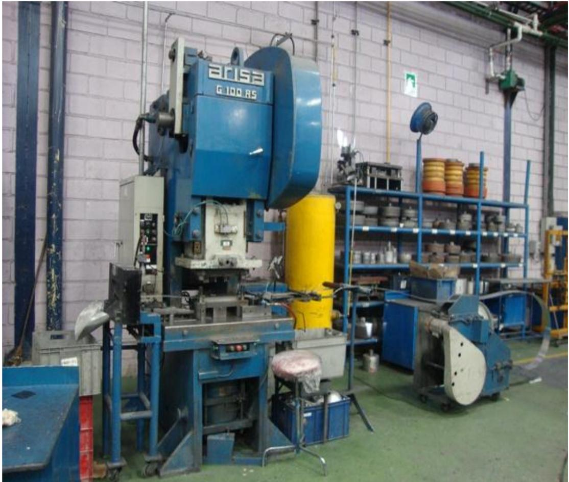
Maquina completa con el alimentador del fleje de aluminio, el cortador y el troquel de la oreja marca de fábrica grande.
