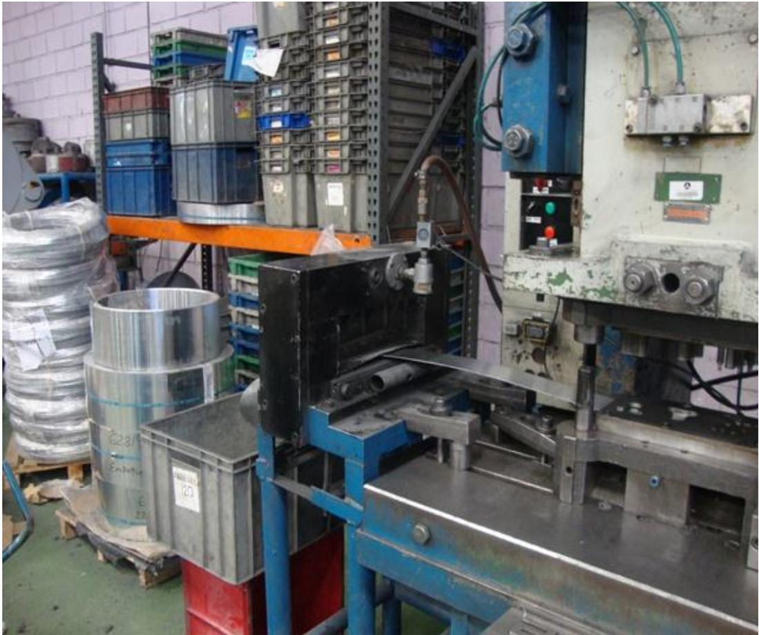
Cortador del fleje de aluminio que sobra después del proceso de troquelado, se corta para su fácil compactación.
