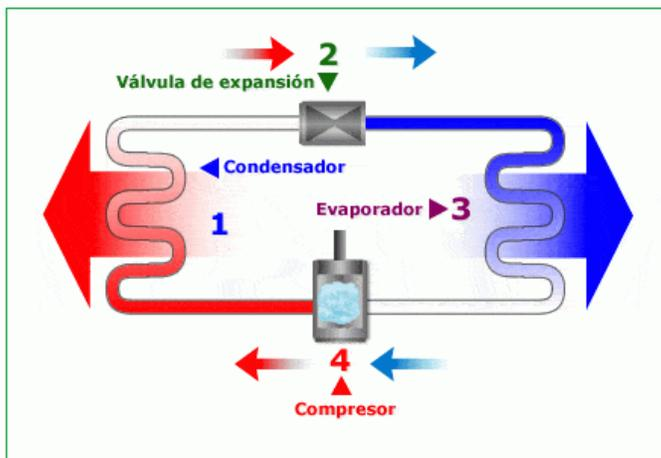
Imagen 3. Sistema de un aire acondicionado tipo Mini split. Fuente: <https://tuair acondicionado.net/el-ciclo-de-refrigeracion-como-funcional/>
