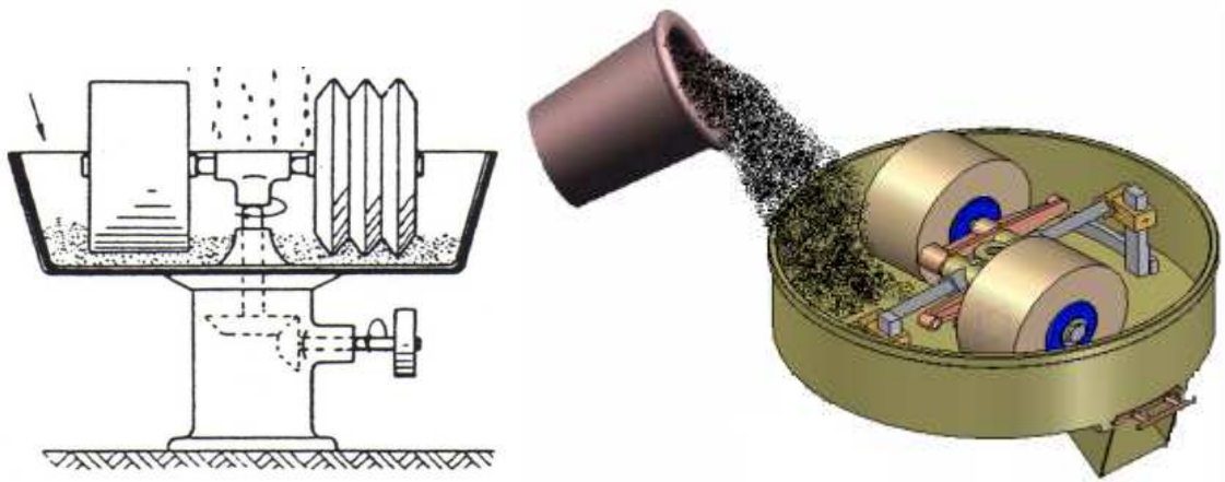
Imagen 5. Molino utilizado en el proceso de fundición
