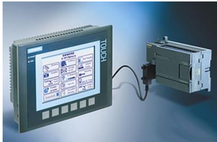
Figura 2. Controladores lógicos programables de estructura semimodular
