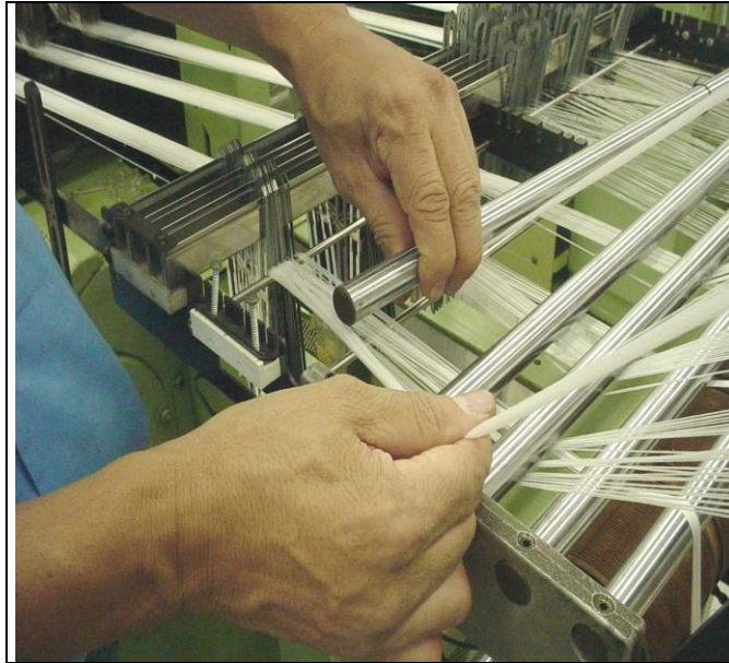
Ilustración 36. Introducir el material en el eje respectivo
