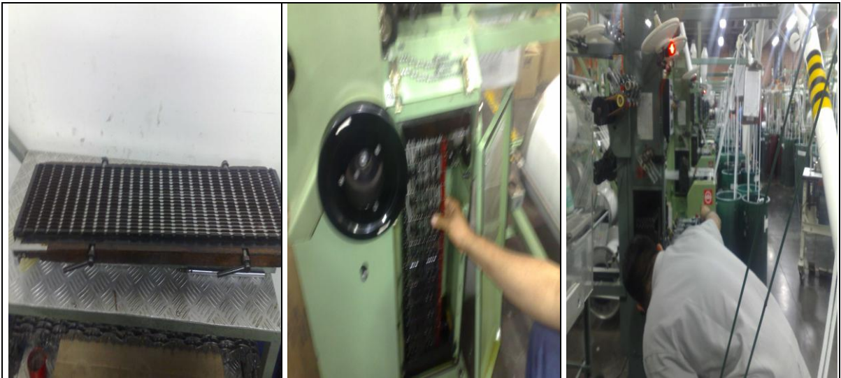
Ilustración 7. El técnico ubica la cadena de los tiempos sobre el banco de trabajo Y reestructura los eslabones para la referencia nueva.
