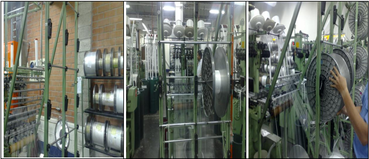
Ilustración 6. El material es montado en el telar según ubicación especificada en la ficha técnica
