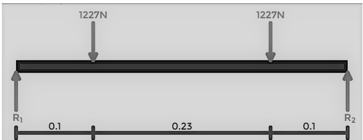
Ilustración 24 Representación, viga de sección circular cargada.
