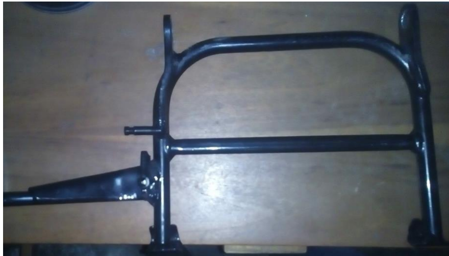
Ilustración 6 Soporte central original de las motocicletas Auteco Kymco Fly y Agility
