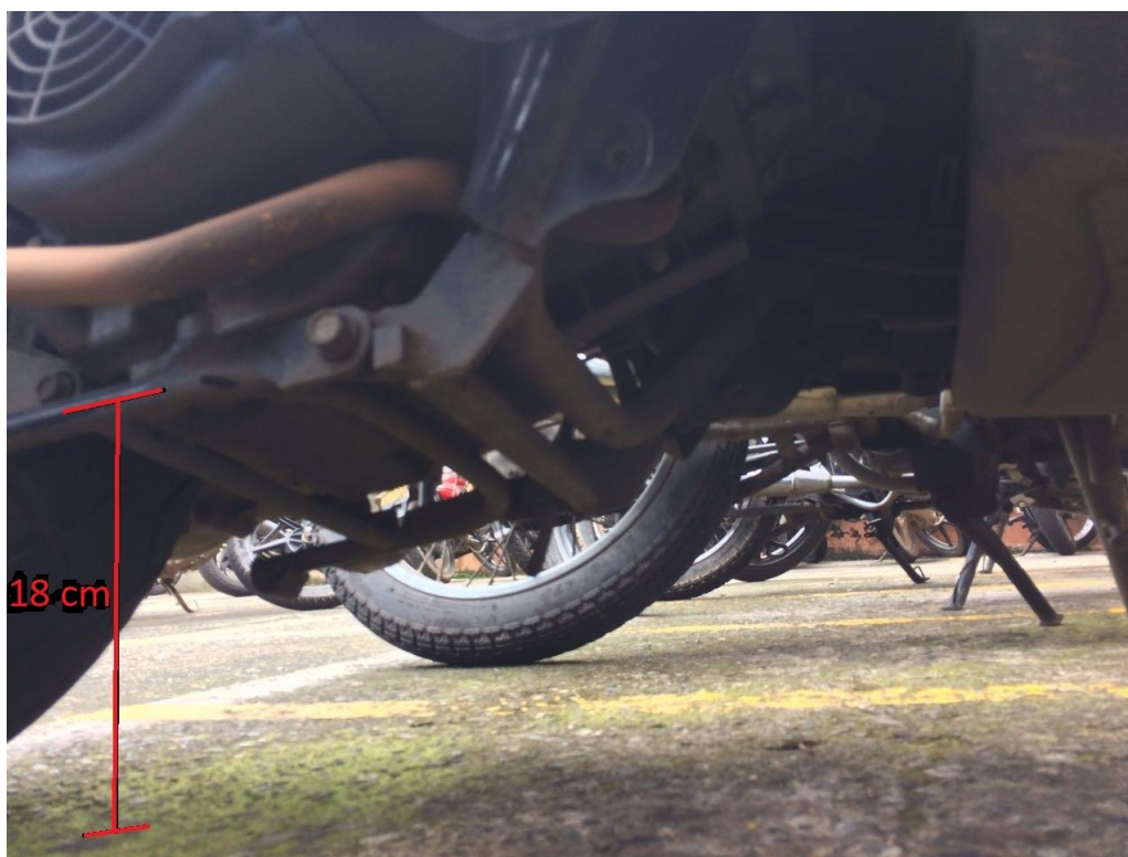
Ilustración 10 Altura del chasis con el soporte doble retraído.
