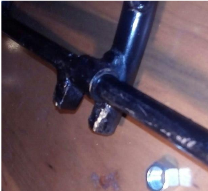
Ilustración 36 Anillo soldado a elemento mecánico
