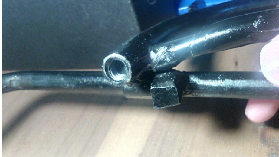
Ilustración 34 Rosca soldada a un tubo.
