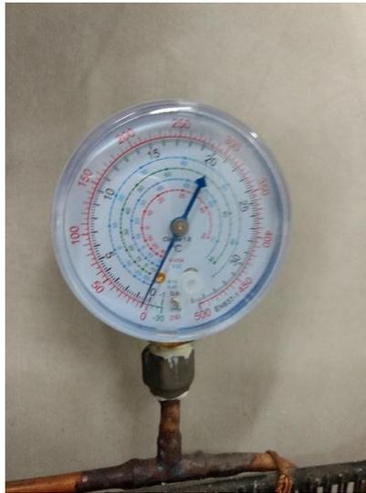
Ilustración 13. Presiones en manómetros. Mide presión de baja.
