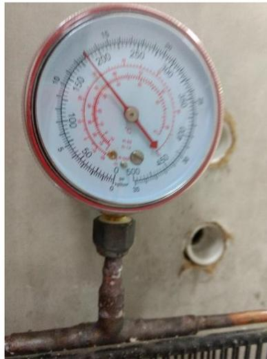
Ilustración 14. Registro de en manómetros, mide presión de alta.
