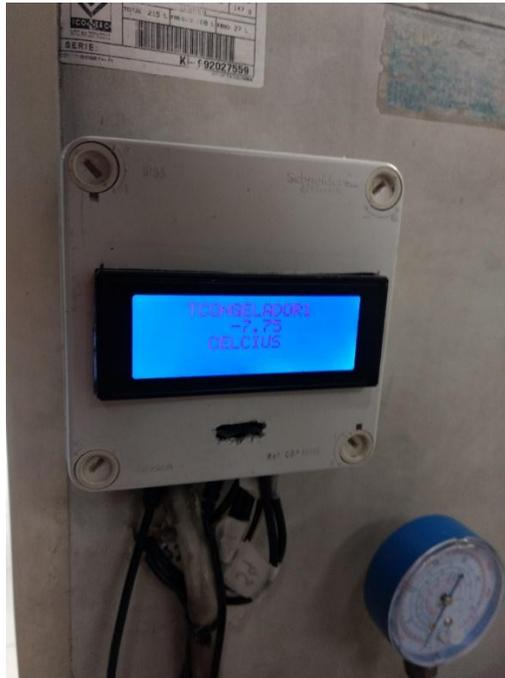
Ilustración 20.registro de datos en la pantalla
