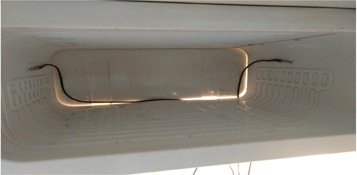
Ilustración 9. Sensores de temperatura instalados en el congelador de alimentos.
