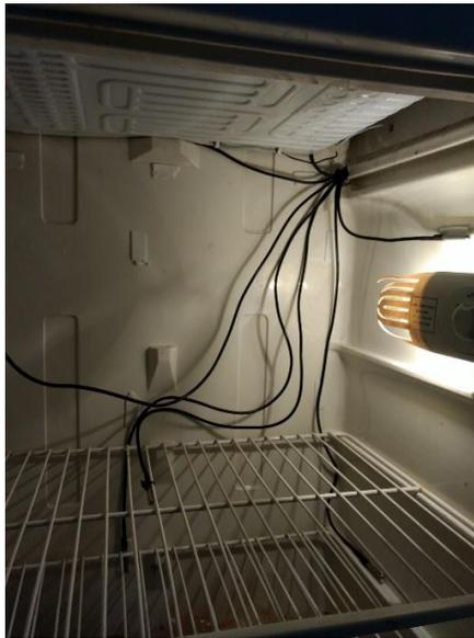
Ilustración 8. Sensores en puntos clave de del refrigerador. Conservación de alimentos
